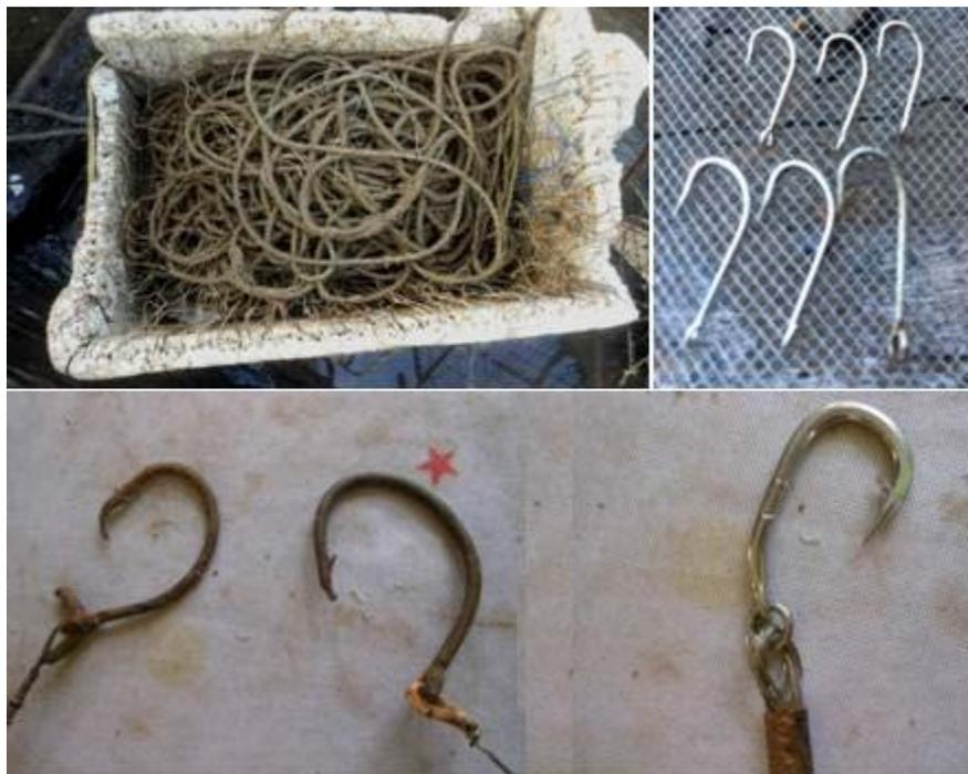
**Figura 8. Palangre y tipos de anzuelo (arriba derecha tipo mustad, abajo izquierda “curveteado”, abajo derecha peruano).**
